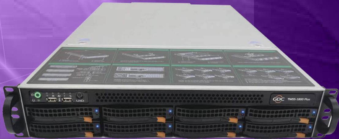
TMSS-1800+ 服务器是GDC专门为影院管理系统软件(TMS)设计的新一代服务器, TMSS-1800+ 服务器采用2U机架式设计,有效地为多厅影院进行集中式管理。TMSS-1800+ 配置不但能够让影院管理系统流畅的运行及处理影院日常操作,而且能够对接GDC的PMA电源管理适配器、ACS自动化控制系统、PSC时序电源控制器等各种自动化产品,并极大限度的兼容各种放映设备厂商的硬件设备。TMSS-1800+ 是多厅影院管理系统的核心。
